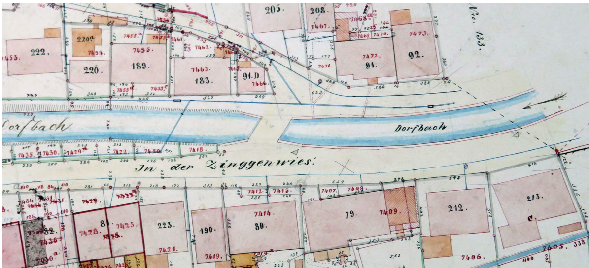
Abb. 33 1857 «Gemarkung Schleitheim. Original=Blatt No. 135 : Maasstab = 1:500 : Martin Bächtold, Geometer». Abschnitt zwischen heutiger Fussgängerbrücke 05, Büchsenbrücke und Hofstatt. Den Bachlauf unterhalb der Büchsenbrücke fassen Böschungen. Q: GEMA Schleitheim, Planschrank II, Katasterpläne Nr.129-137.
