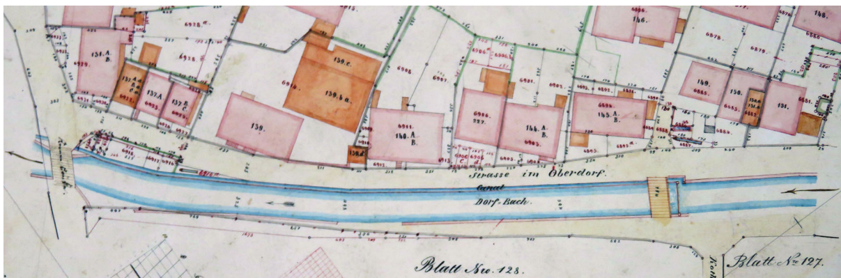
Abb. 15 1857 «Gemarkung Schleithelm. Original=Blatt No. 129 : Maasstab = 1:500 : Martin Bächtold, Geometer». Abschnitt zwischen Beggingerstrasse 27 und Kronenbrücke. Eingetragen sind das Wehr oberhalb der Eberlibrücke, dessen Kanal noch auf der nordseitigen Bachmauerkrone verläuft. Von der linksufrigen Bachmauer ist einzig der Abschnitt zwischen Eberlibrücke und Bachstrasse 4 fertiggestellt, der Abschnitt unterhalb Haus Frohsinn ist in Planung begriffen oder nachgetragen. Auffallend ist hier der landseitige Verlauf der Ufermauer zwischen heutiger Fussgängerbrücke 02 und Kronenbrücke Q: GemA Schleithelm, Planschrank II, Katasterpläne Nr.129-137.
